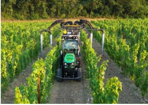
Mit dem Smart Vineyard Tractor stellt DEUTZ-FAHR das Konzept des „Traktors als Sensor“ vor, das dem Traktor innovative Funktionen wie unbemanntes Fahren, autonomes Gerätemanagement und die Erfassung von agronomischen Daten zur Ernteüberwachung ermöglicht. Mit einer Reihe von Sensoren und einer leistungs-
