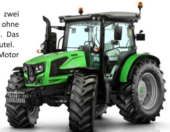
Die neue Serie 5 Keyline von 75 bis 106 PS verfügt mit dem **5075 Keyline**, ebenfalls über ein Modell mit 4-Zylinder Motor, 34 Zoll Heckbereifung, ohne ADBLUE Abgasnachbehandlung.
