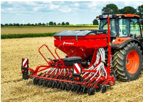
Die Kverneland Satio ist eine kompakte und leichte 3-Punkt-Solo-Sämaschine für kleinere Traktoren. Die Aussaat kann unabhängig von der Saattbettvorbereitung mit höherer Geschwindigkeit durchgeführt werden. Sie vergrößert das Zeitfenster für die Aussaat, auch bei schwierigen Witterungsbedingungen. Bodenverdichtung oder Fahrspuren des Traktors wer-
