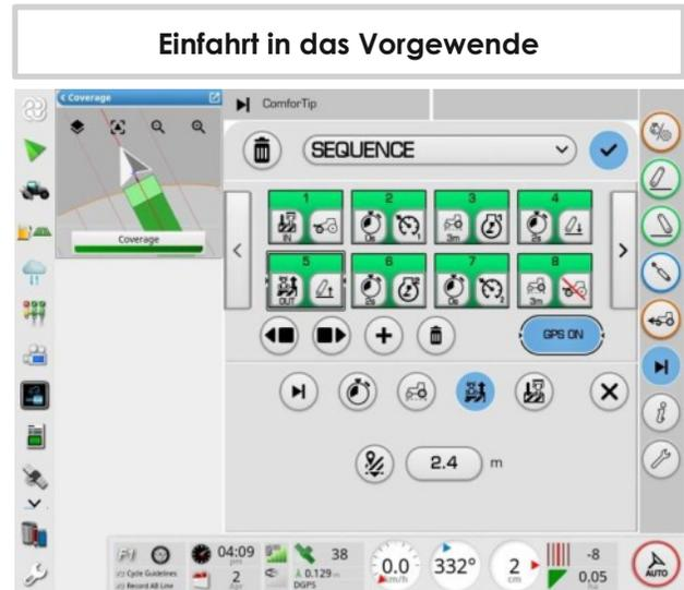
Nach Aktivierung des GPS-Hauptschalters im ComforTip-Menü, können Sie die entsprechenden automatischen Auslöser einstellen. Sie haben die Möglichkeit zwei getrennte Auslöser zu aktivieren, einmal für das Verlassen des Vorgewendes und einmal für die Einfahrt in das Vorgewende. Zur Feinabstimmung der Einstellung kann der Bediener einen bestimmten Abstand zur Vorgewendelinie einstellen. Durch drücken der „Lerntaste“ kann der Abstand auch automatisch bestimmt werden.
